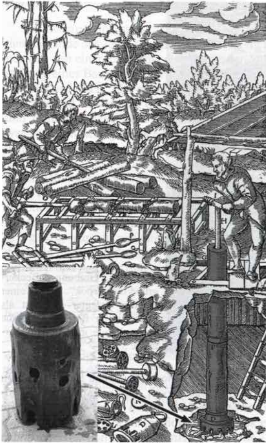
Abb. 10: Grabung „Beckergrube/Ellerbrook“. Hölzerne Saugpumpe mit Rückschlagventil (oben) vom Grundstück Fischergube 61 und Darstellung des Gebrauchs (aus: Georg Agricola, Zwölf Bücher vom Berg- und Hüttenwesen, 6. Buch, Nachdruck Berlin 1928, Abb. S. 148).
