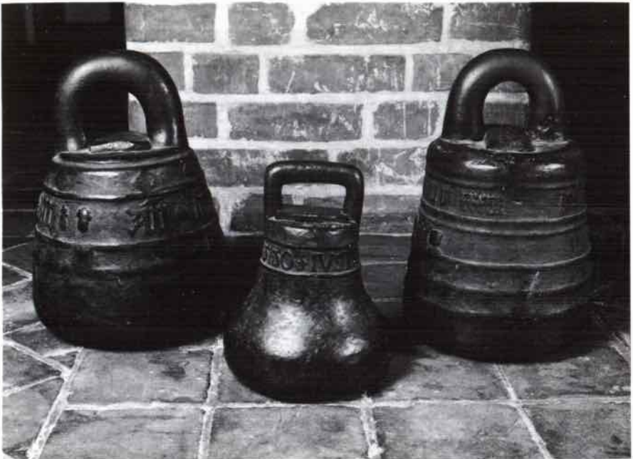
Abb. 1. Der Zentner nach Z 31 aus dem Jahr 1550 steht zwischen den beiden Schiffpfunden nach Z 30. Die zwischen den Handgriffen der Gewichtstücke eingepreßten (?) Flachstege überdecken wahrscheinlich die Justierhöhlungen.
