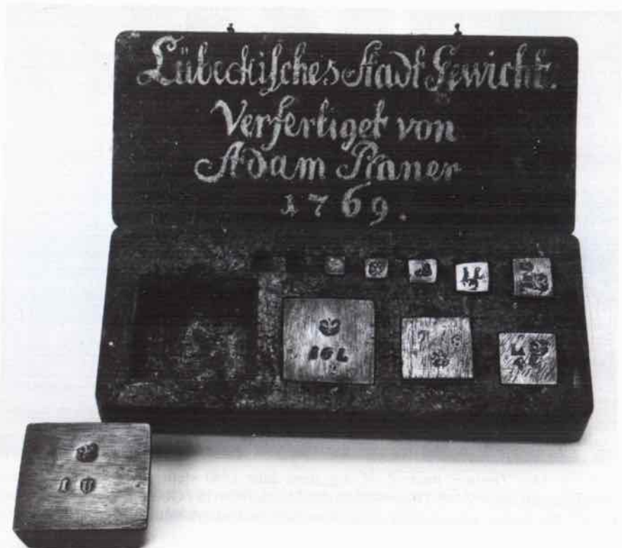
Abb. 2. Das herausgenommene Pfund des Stadtgewichts von 1769 nach Z 25 hat die Form eines 23 mm hohen Pyramidenstumpfes. Die Kantenlängen sind oben 55 mm bzw. 53 mm und unten 47 mm bzw. 43 mm.
