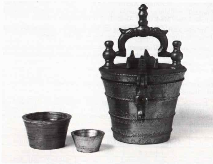
Abb. 5. Ein sog. Nürnberger Einsatzgewicht, das aus ineinander gesteckten konischen Schalen besteht. Es war im 17. und 18. Jahrhundert weit verbreitet. Die jeweils größere Schale hat die doppelte Masse der vorhergehenden.
