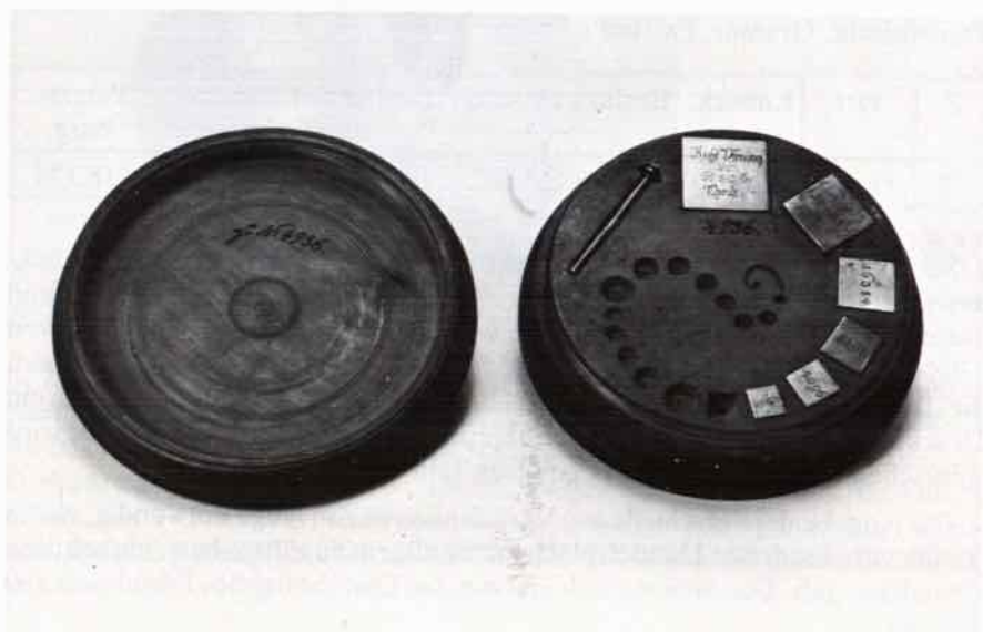
Abb. 4. In diesem jetzt nur noch lückenhaft gefüllten Kasten Nr. 4936 waren ursprünglich 20 Münzgewichte bis zur Größe von 65536 Richtpfennigteilen spiralförmig angeordnet. Mit einem Durchstecher konnten sie durch Bohrungen von unten aus ihren Lagerungen herausgedrückt werden.
