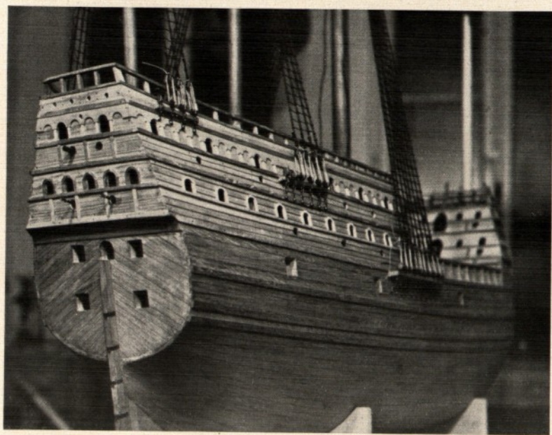
oben: Schiffsform im Gerippe unten: Das Holzwerk des Hinterschiffes
